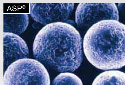
Dagegen verfügen die ASP®-Stähle über kleinere Karbid-Körner, die homogen verteilt sind. (Mit freundlicher Genehmigung von Erasteel).
